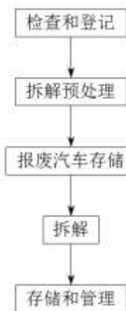
图 2.5-1 报废汽车回收拆解作业程序图
