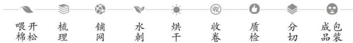
图 4.1-4 面膜布生产工艺
